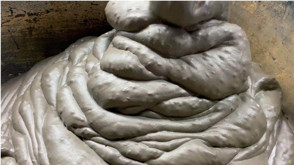
Abb. 6: Aeroleichtbeton (500 kg/m<sup>3</sup>) Testproduktion mit ca. 1 m<sup>3</sup>/min Produktionsgeschwindigkeit
