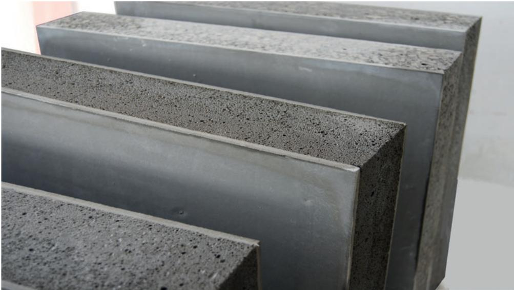
Abb. 8: Hybridbeton-Elemente mit UHPC-Deckschicht -
