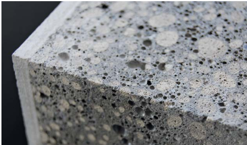
Spezifische Materialmatrix der Hybridbeton-Elemente mit Aerogel-Schaumbetonkern.
