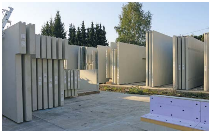
Lagerung von Wandelementen im Werk.
