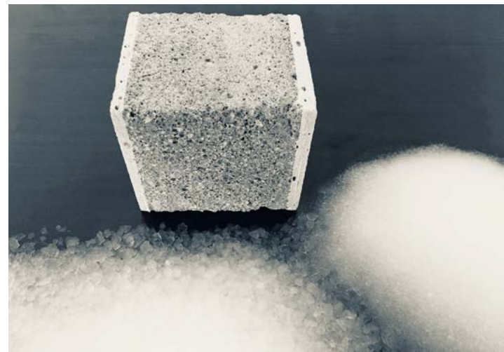
Schaumbetonprobekörper in Kombination mit Aerogelpulver.
